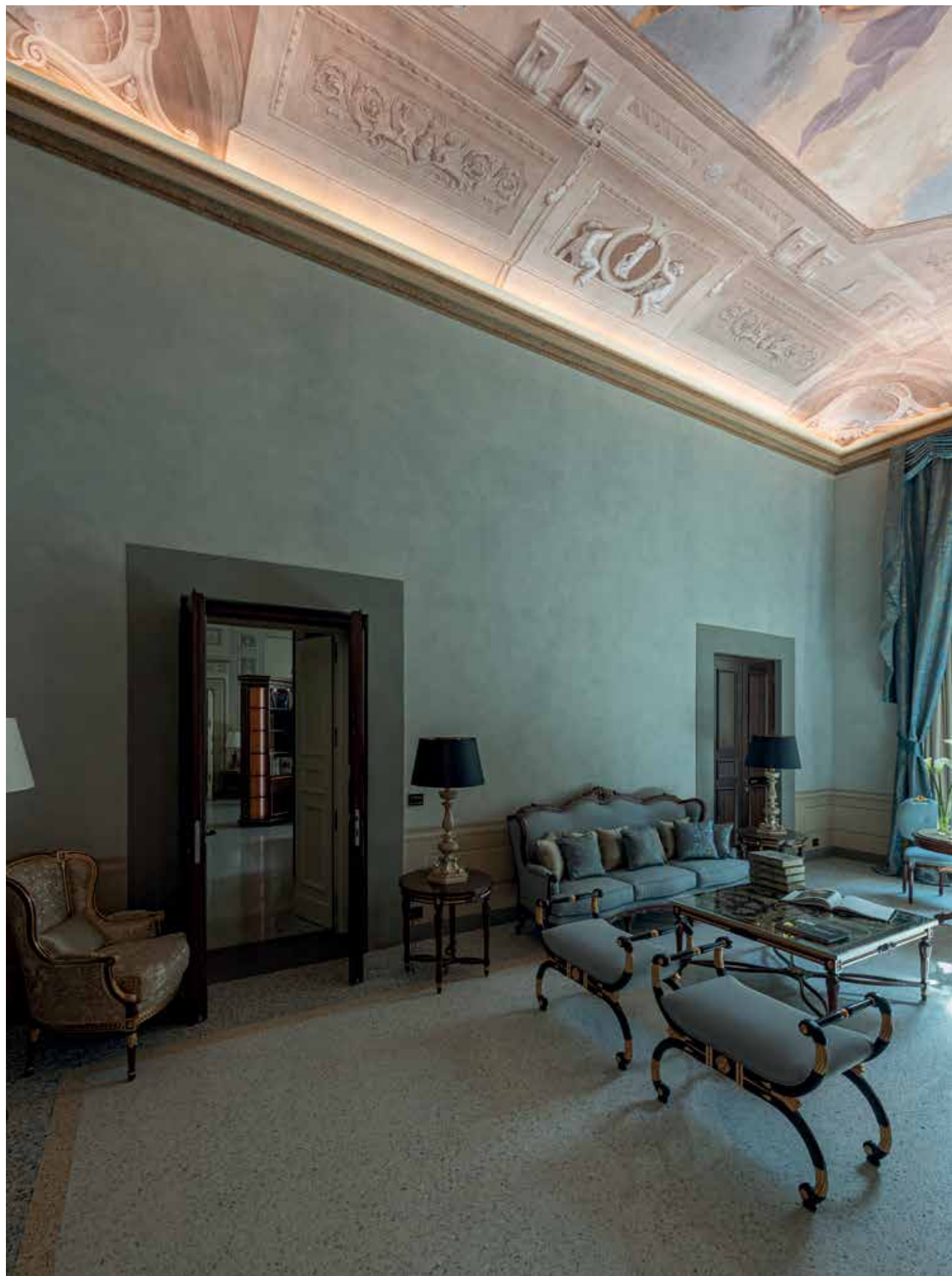
Stanza 104 all'interno di Palazzo Portinari Salviati, Firenze. Apparecchio Glance-In per un'illuminazione uniforme e omogenea su tutto il soffitto della stanza, progettato per valorizzare gli affreschi e l'ambiente, e integrarsi in modo discreto nell'ambiente. Progetto: ESA Engineering.
